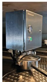
LE SYSTÈME AROMALOC se présente comme un boîtier en inox fixé au dessus de la cuve.
